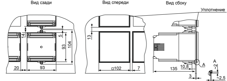
Рисунок 3 – Прибор в корпусе Щ4, установленный в щит толщиной 3 мм
