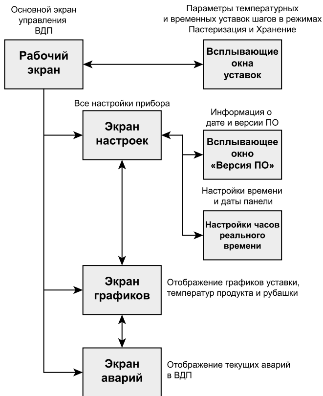
Рисунок 8.5 – Схема переходов между экранами панели
